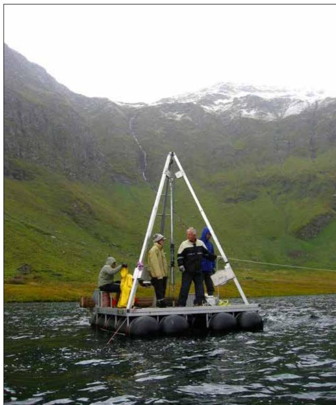
*Scene di lavoro sul Lago di Cadagno. Attrezzatura che permette il prelievo di sedimenti. Campionamenti effettuati mediante carotaggio.*
