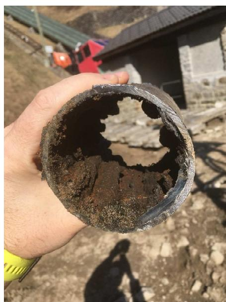
*Stato interno delle tubazioni in ghisa sostituite zona Sanatorio*
